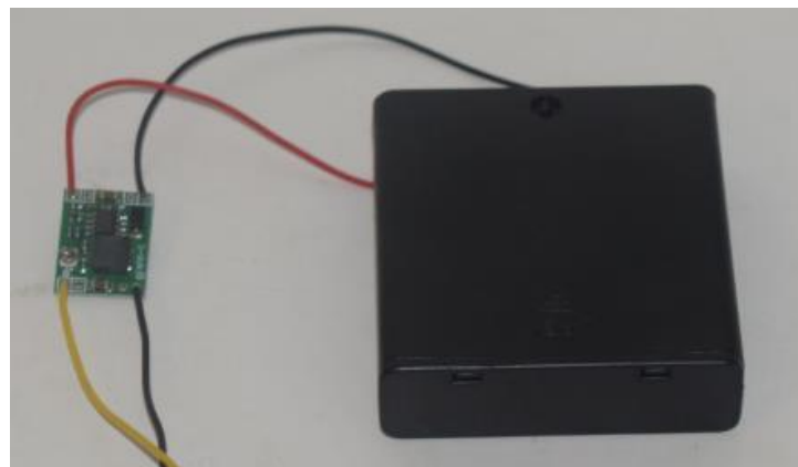
Figura 120 Fuente alimentación MKRFOX 1200
