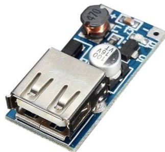
Figura 123 Fuente conmutada elevadora
